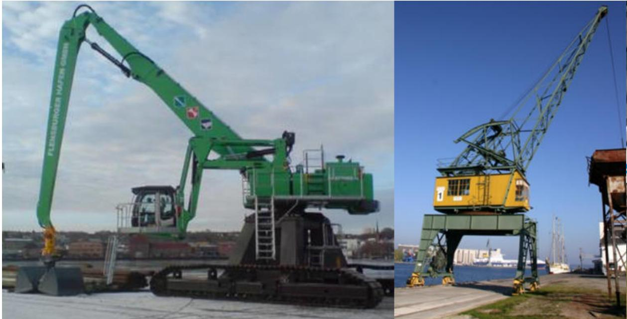
**Abbildung 8: Umschlagmaschinen Hafen-Ostseite: links: Mantsinen RHC 60, rechts: Kran 1**
